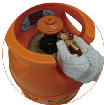
Step 7 安裝超流量遮斷器
